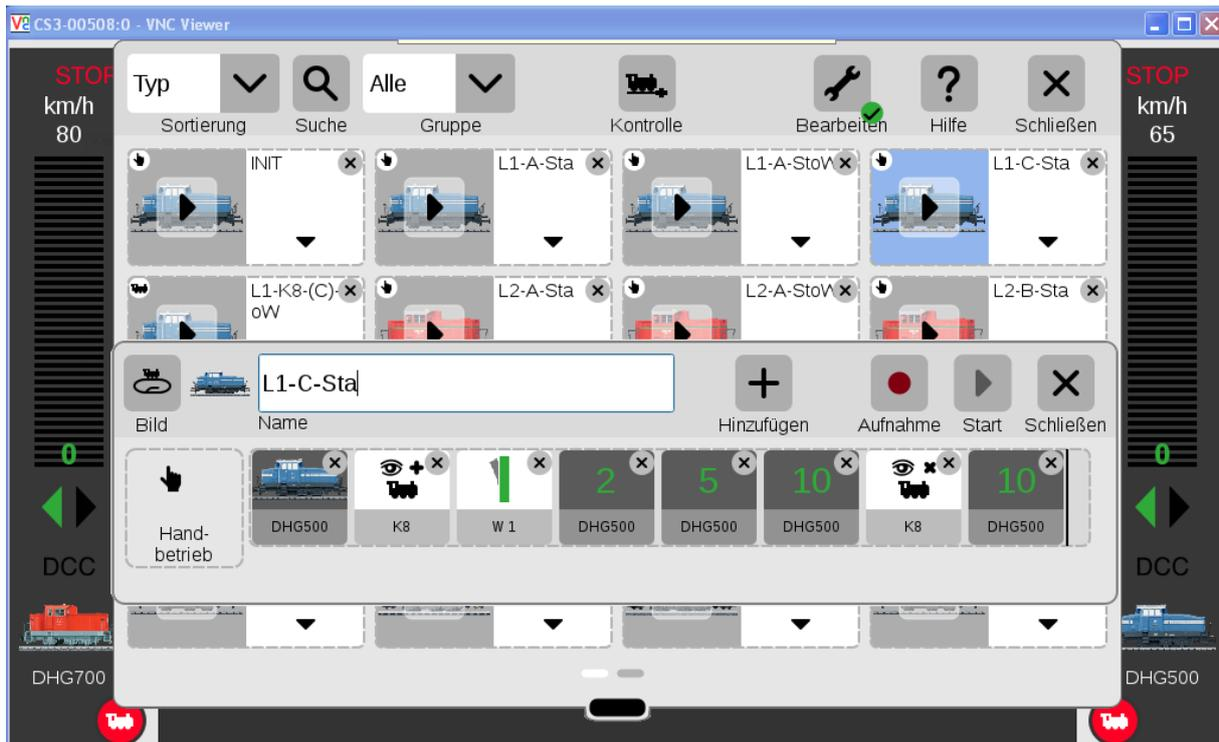
**Abbildung 7: Vergleichsweise übersichtlich die Ereignisabfolge L1-C-Sta, mit der die Weiche auf gerade geschaltet wird und die blaue Lok Richtung A startet.**
