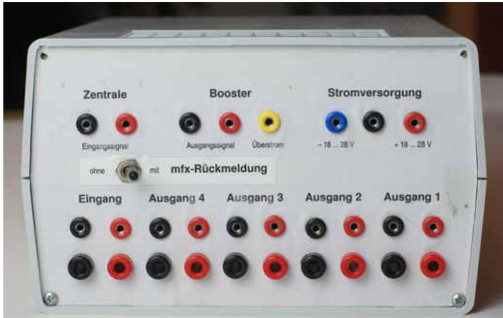
Die Bedien- und Anzeigeelemente der AutoFuse Deluxe, die beim Prototyp in einem eigenen Gehäuse untergebracht wurden.
