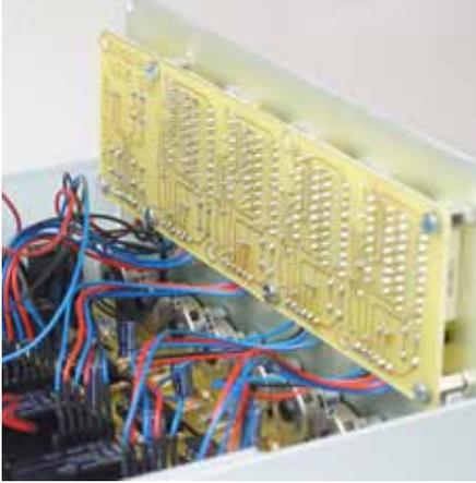
Die Anzeigeplatine und die Basisplatine sind mit einigen Kabeln verbunden. Hier wurden einzelne Litzen in verschiedenen Farben genutzt. Man kann aber auch Flachbandkabel verwenden.
