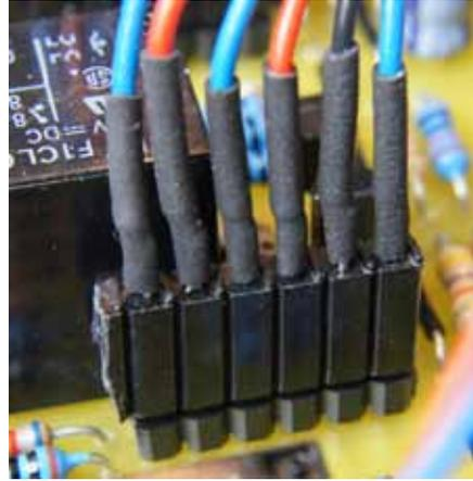
Die Verbindung zur Anzeigeplatine übernehmen selbstgebaute Stecker aus Buchsenleisten.
