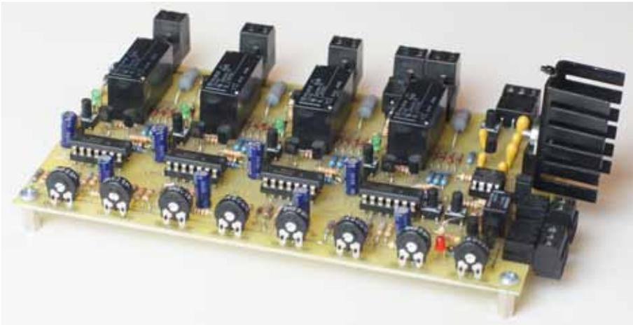
Die AutoFuse Deluxe kann auch ohne Bedienelemente und Anzeigeplatine betrieben werden. Das Foto zeigt noch den Prototyp mit improvisiertem Kühlkörper.
