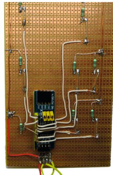
Die Verdrahtung der LEDs erfolgt von hinten über eine Lochrasterplatine.
