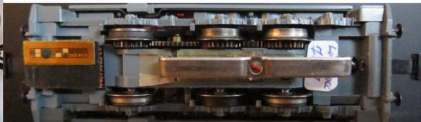
Der TAG - so lautet die Konvention - muss auf der Seite angebracht sein, wo sich bei Fleischmannloks der Schaltpilz befindet. Bei typischen Dampfloks auf der Lokführerseite, also Blick vom Führerstand auf den Schornstein unter der rechten Fahrzeughälfte, bei Dieselloks, wie der DHG500 oder der V60 gilt der längere Vorbau als vorn. Bei symmetrisch erscheinenden Loks mit zwei Führerständen gilt natürlich die entsprechende Kennzeichnung 1(V) und 2(H).
