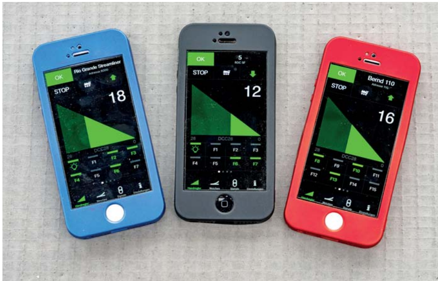
Auf drei iPhones 5s läuft je eine Instanz der TouchCab-App im Parallelbetrieb an einer Esu-ECoS.
