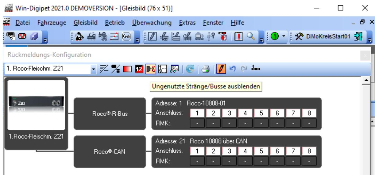
*Hier sind zwei Roco 10808 für die schwarze Z21 konfiguriert. Oben mit der Adresse 1 am R-Bus, unten mit der Adresse 21 am CAN-Bus. Nach erfolgreicher Konfiguration wird der Rückmeldungs-Konfigurations-Dialog mit Klick auf das X in der rechten oberen Ecke geschlossen. Nach Bestätigung des Rückfragedialogs werden die Daten ins Programm übernommen.*
